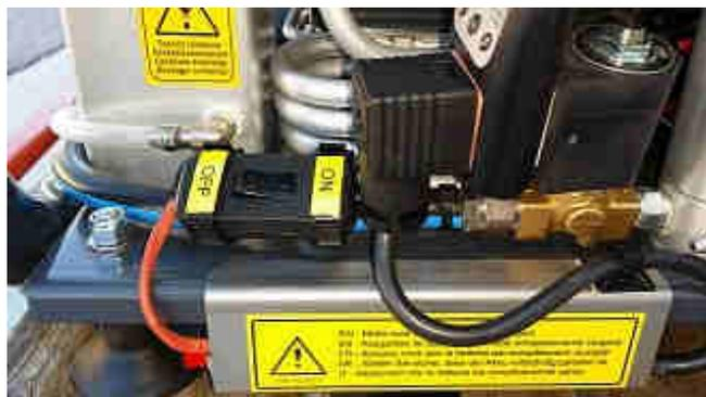
Pour recharger la batterie, il faut la sortir de son emplacement en démontant le support en inox. Pour ce faire, il suffit d'enlever les deux vis boulons au moyen d'une clé Allen.
