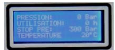
Indication de la pression de redémarrage du Compresseur, dans le cas ou celui-ci est en fonctionnement AUTOMATIQUE. La pression est réglable de 0 à 30 bars sous la pression d'arrêt préréglée. (ex. press.max. 300 bar , press.min. 270 bar)
