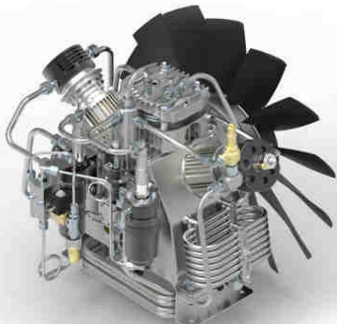
Les paliers du vilebrequin sont montés sur des roulements extrêmement robuste, fabriqués en Europe, garantissant une longue durée de vie au compresseur. La pompe à huile procure une lubrification constante pendant le fonctionnement, l'huile étant débarrassée des impuretés grâce à un filtre, et un bouchon aimanté qui récupère toutes les particules métalliques présentes dans l'huile. Le refroidissement inter étages du gaz comprimé est assuré par des serpentins en acier inox.
