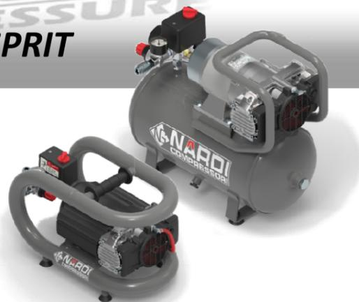
L'Esprit 3 T est un compresseur bicylindre à plat. Il a la particularité d'utiliser un châssis servant également de réservoir tampon (3 litres à 10 bars). Plus performant que le Silverstone, il n'est pas destiné à une utilisation intensive, mais est capable d'alimenter un cloueur, une soufflette, et même servir de gonfleur. Il existe en 220 volts, 12 volts ou 24 volts, et même avec une cuve de 10 ou 15 litres. Il existe soit en version 60/4, très silencieuse, soit en 60/2 plus performante.
