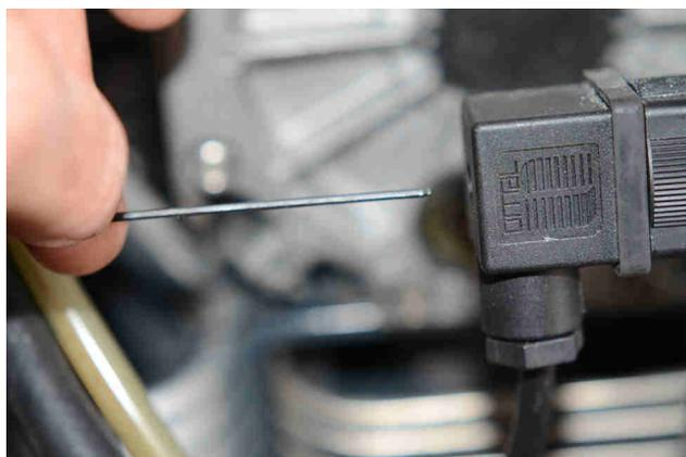
En serrant la clé, on augmente la pression d'arrêt, en desserrant, on la diminue.
