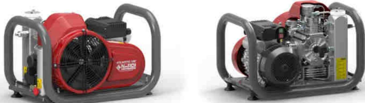
Electrique: il existe en 220 volts monophasé, ou en 380 volts triphasé. Attention en cas d'utilisation avec un groupe électrogène. La consommation électrique au démarrage est très importante, il faut prévoir environ 3 fois la puissance du moteur. Il ne faut jamais l'utiliser avec une rallonge électrique.
