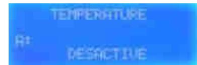
Réglage de la température à laquelle l'alarme doit se déclencher. Ce réglage est possible uniquement si le capteur est activé, sinon, cette indication ne sera pas visible. Si le compresseur atteint la limite de température autorisée, il s'arrêtera automatiquement, une alarme sera déclenchée, et l'écran indiquera quel capteur est concerné.
